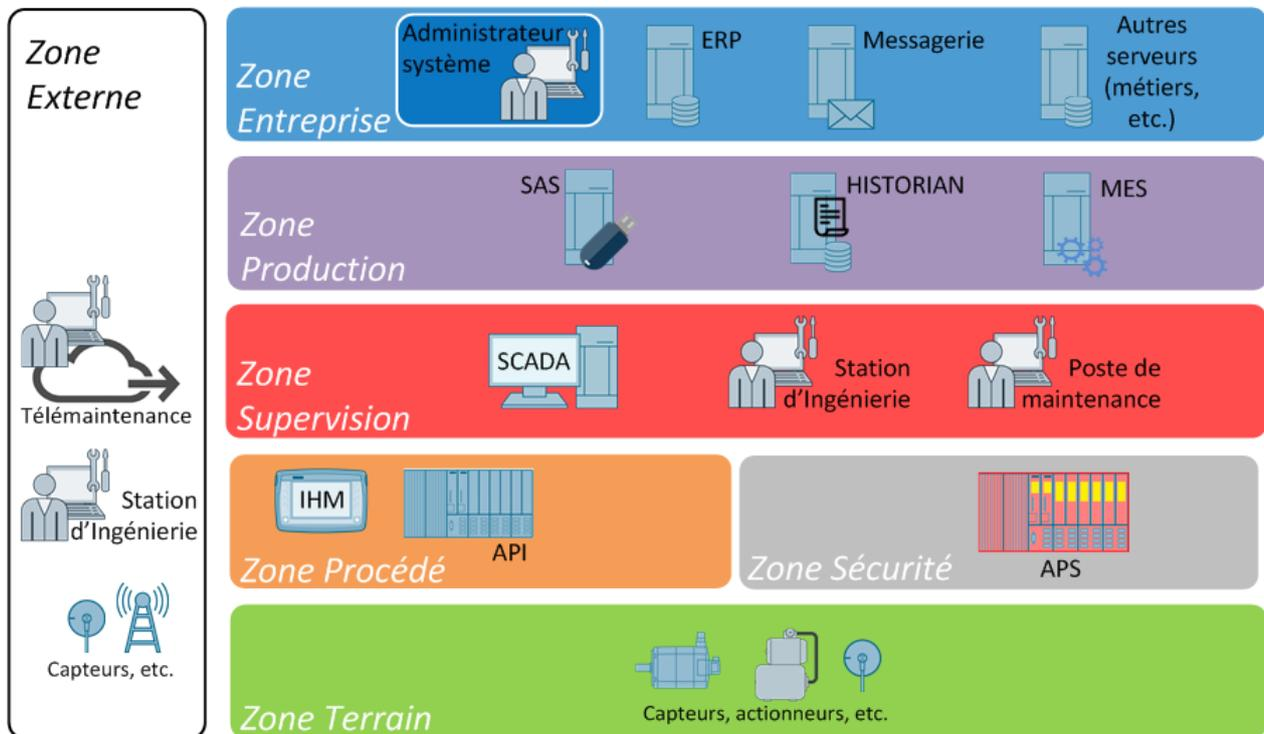
FIGURE 3.1 – Découpage des fonctions selon le modèle Purdue
